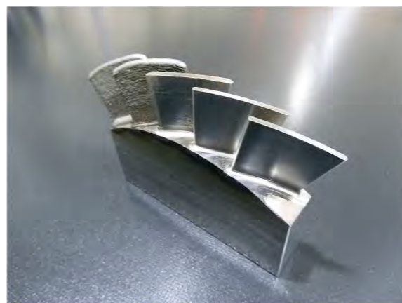
3Dプリンターで造形した航空機エンジン部品のサンプルワーク
